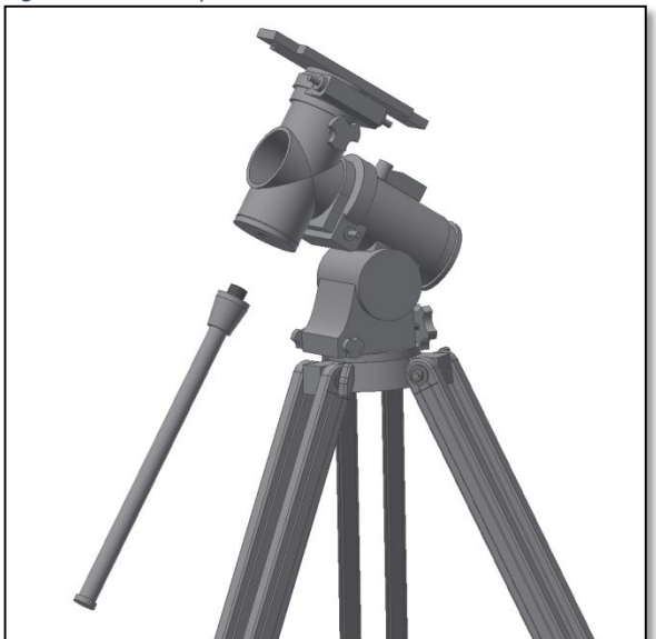
Fig. 5. Fixation de la barre de contrepoids.
