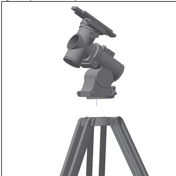
Fig. 4. Mise en place de la monture équatoriale.
