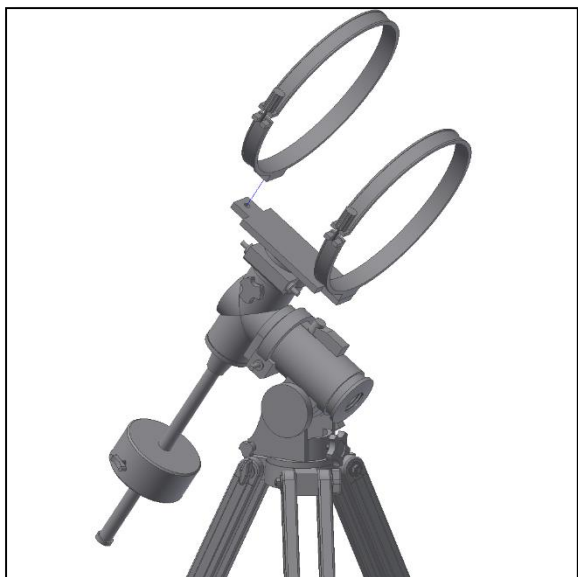
Fig. 7. Montage et serrage des colliers.
